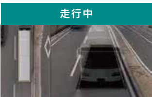
通常ビュー 走行時は左右後方の車両周辺が確認でき、バス停などの発進時は車両前方の確認も可能
