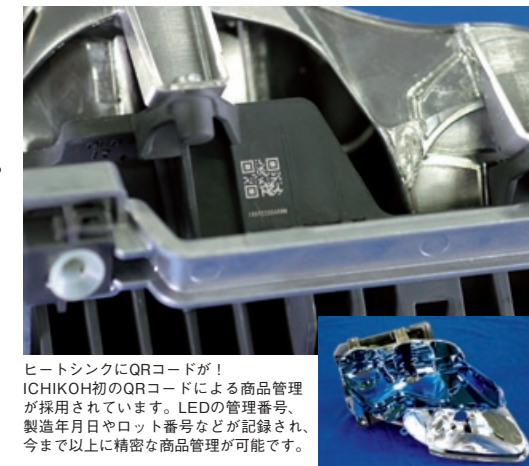
光学モジュールで、今、最も厄介者あつかいな部品が、数百gもあるアルミ製のヒートシンク(写真の黒いフィン部分)です。これらの部品は、LEDの熱を放熱し、LEDの性能や信頼性を確保する重要な部品ですが、出来るだけ小さいほうが良いのです。
