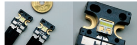
黄色い1mm.角の正方形が1つのチップ。この製品は、横一列に並んだLED 4個で構成されたマルチチップです。
