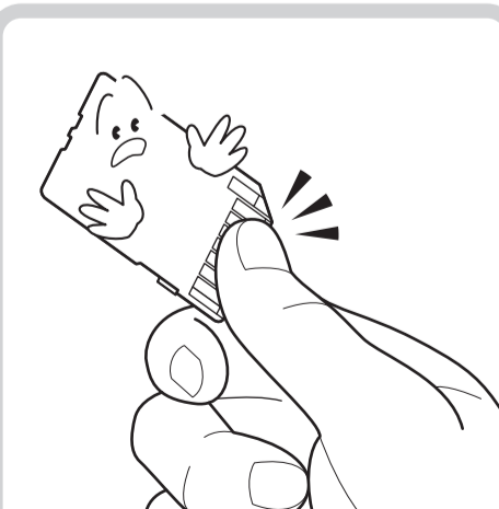
SDカードの端子部に素手で触れないこと
