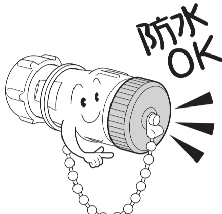
ダイヤル付きコネクター(キャップ付き)未使用時は、コネクター内部に水が入らないようにキャップを閉めること
