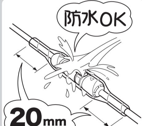
室外設置時は水がかかりやすい部位にビニールテープやフチルテープ、シール剤等を用いて止水処理を施すこと(対象物の最低20mm前後をラップしてください)
